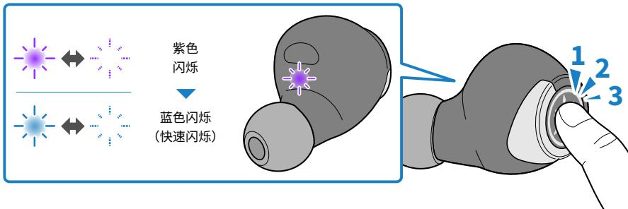
如果几秒钟后指示灯按如下显示亮起，表明初始化成功，耳机已进入与 Bluetooth 设备配对模式。如果指示器没有按如下显示，请从第 1 步开始尝试再次初始化。
