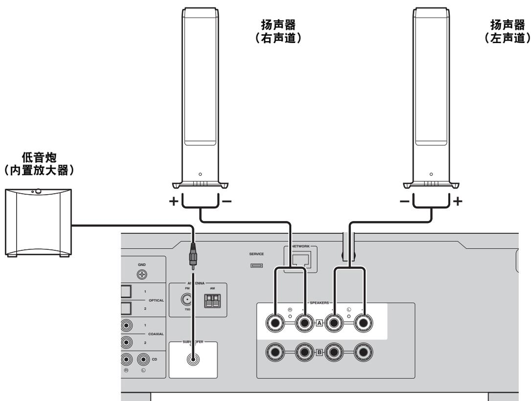
**1** 剥去喇叭线端部约 10 mm 的绝缘皮，并将其线芯紧捻在一起。
