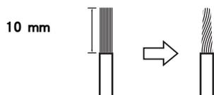
**2** 将音箱插孔的旋钮向左转动松开，然后将喇叭线的线芯插入插孔的孔中。
