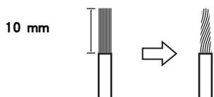
2 将音箱插孔的旋钮向左旋转以将其松开，然后将音箱缆线的芯线插入插孔中。
