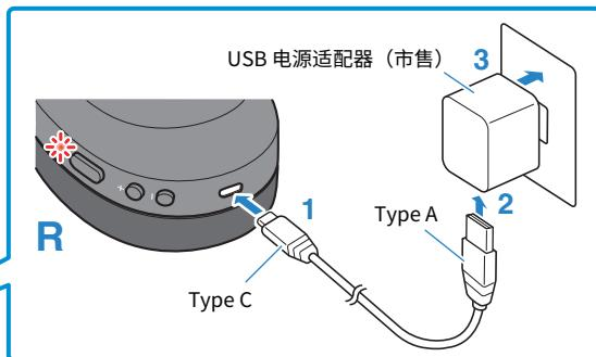
**1 将 USB 电源线 (Type C 一侧) 插入耳机充电连接器。**
