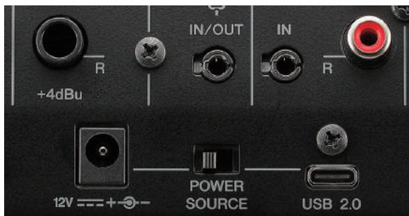
除了为移动应用准备的1.5A USB母线供电外，为实现更稳定的操作，AG08还配备了全新的PA-150B专用AC电源适配器。
