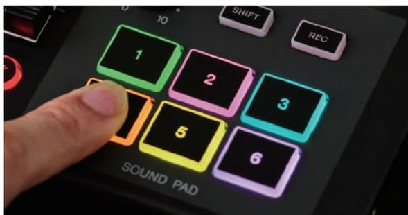
AG08自带6个可自定义的打击垫，可便捷且实时地添加音效，活跃播客氛围。使用专用应用程序“AG08 Controller”即可轻松拖曳现有声音文件，将其分配到所选的打击垫中，或通过AG08的输入录制自己的采样，并在应用程序中将其修剪为所需长度。
